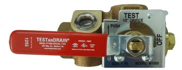
As Válvulas Testandrain® Modelo 1000 são válvulas do tipo esfera, com três posições de parada da alavanca: OFF, TEST e DRAIN. Elas realizam o fechamento do sistema para teste funcional, através de um orifício calibrado, que simula a abertura de um sprinkler e do dreno do sistema, através da passagem no diâmetro nominal da válvula.
